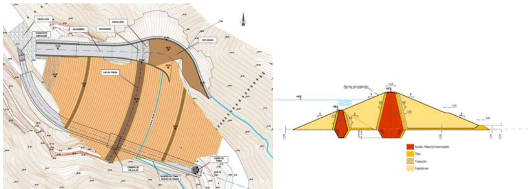
Figura 6. Solución de materiales sueltos propuesta en el estudio de tipologías
