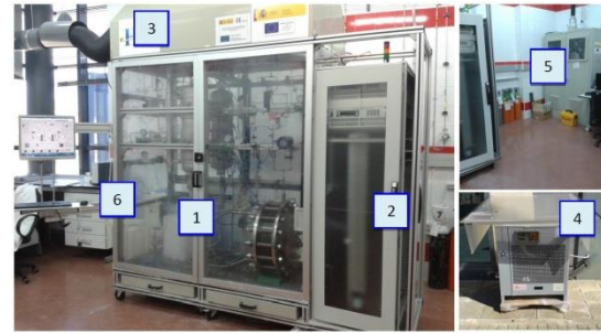
Fig. 2. Banco de ensayos de electrólisis alcalina de 15 kW desarrollado por el CNH2
