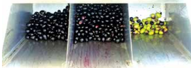
Figura 1. MultiscanS30B a pie de la línea de recepción en la almazara La Pontezuela (izquierda) (a). Detalle de las 3 salidas de la línea con las categorías de color establecidas (izq.: negras, centro: moradas, dcha.: verdes) (b).
