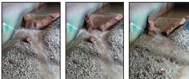
Figura 4: Secuencia del segundo episodio de rotura del núcleo delgado
