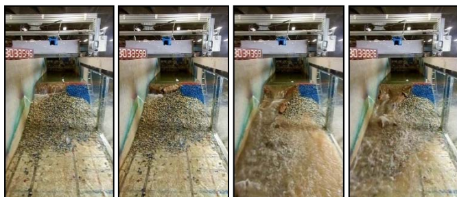
Figura 3: Secuencia del primer episodio de rotura del núcleo delgado
