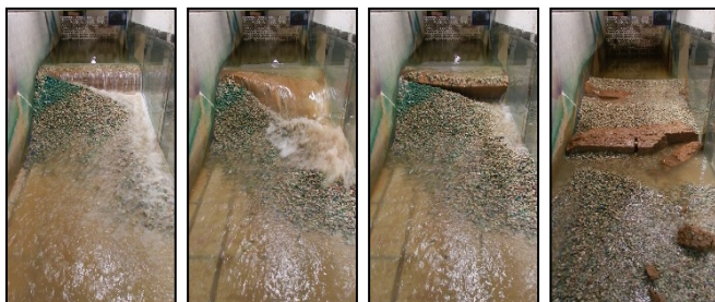
Figura 2: Secuencia de rotura del núcleo grueso
