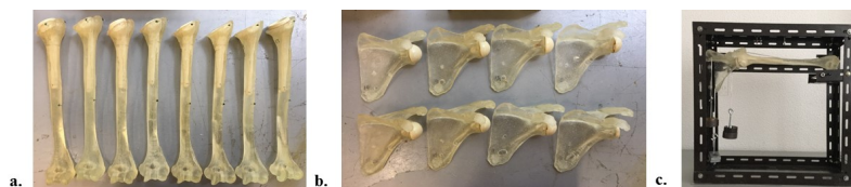
Figura 1. a. Húmeros-prótesis. b. Escápulas-prótesis. c. Montaje para ensayos de estabilidad y movilidad.
