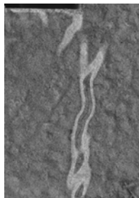
Figura 4: Probeta HRFP BR 6 en el momento de su fisuración.
