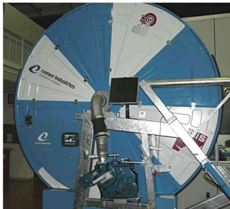
Allestimento di un irrigatore a naspo con apparato meccatronico.
