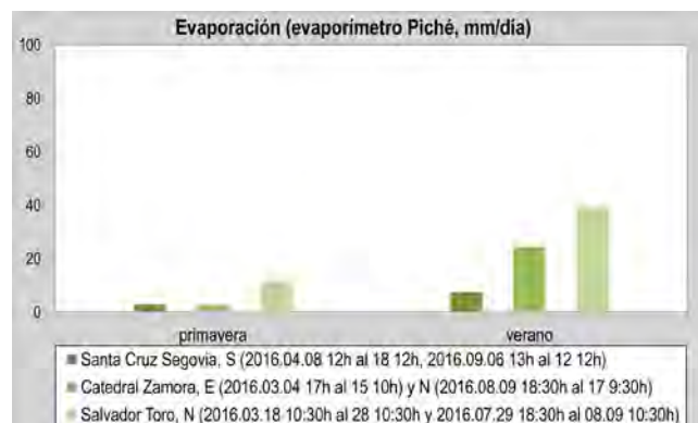
Figura 9. Comportamiento higrométrico y evaporación de distintas cámaras (Santa Cruz de Segovia, catedral de Zamora y San Salvador de Toro) en periodos de precipitación (primavera) y seco (verano): a) humedad relativa; b) evaporación.
