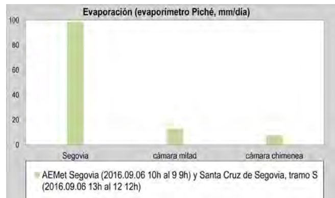
Figura 3. Comportamiento higrométrico y evaporación de la cámara de drenaje-aireación de la iglesia de Santa Cruz la Real de Segovia respecto al clima local: a) y b) humedad relativa y evaporación en las distintas estaciones meteorológicas; c) evaporación en dos puntos del recorrido en periodo seco.
