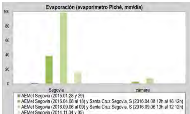
Figura 3. Comportamiento higrométrico y evaporación de la cámara de drenaje-aireación de la iglesia de Santa Cruz la Real de Segovia respecto al clima local: a) y b) humedad relativa y evaporación en las distintas estaciones meteorológicas; c) evaporación en dos puntos del recorrido en periodo seco.
