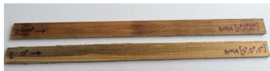
Figura 6 Probeta a tracción longitudinal, del Biocomposite Bambú-PLA
