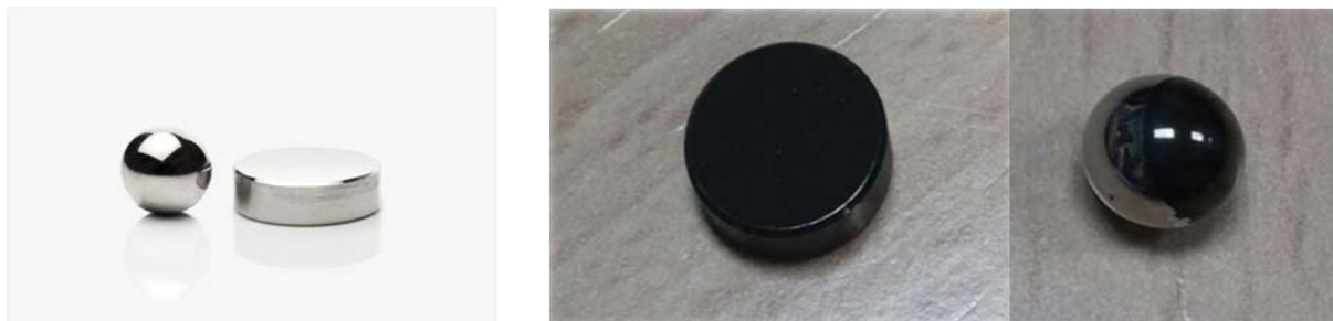
Figura 2. Probetas del tribómetro HFRR: sin recubrir (izqu.) y recubiertas de CDLC (der.)
