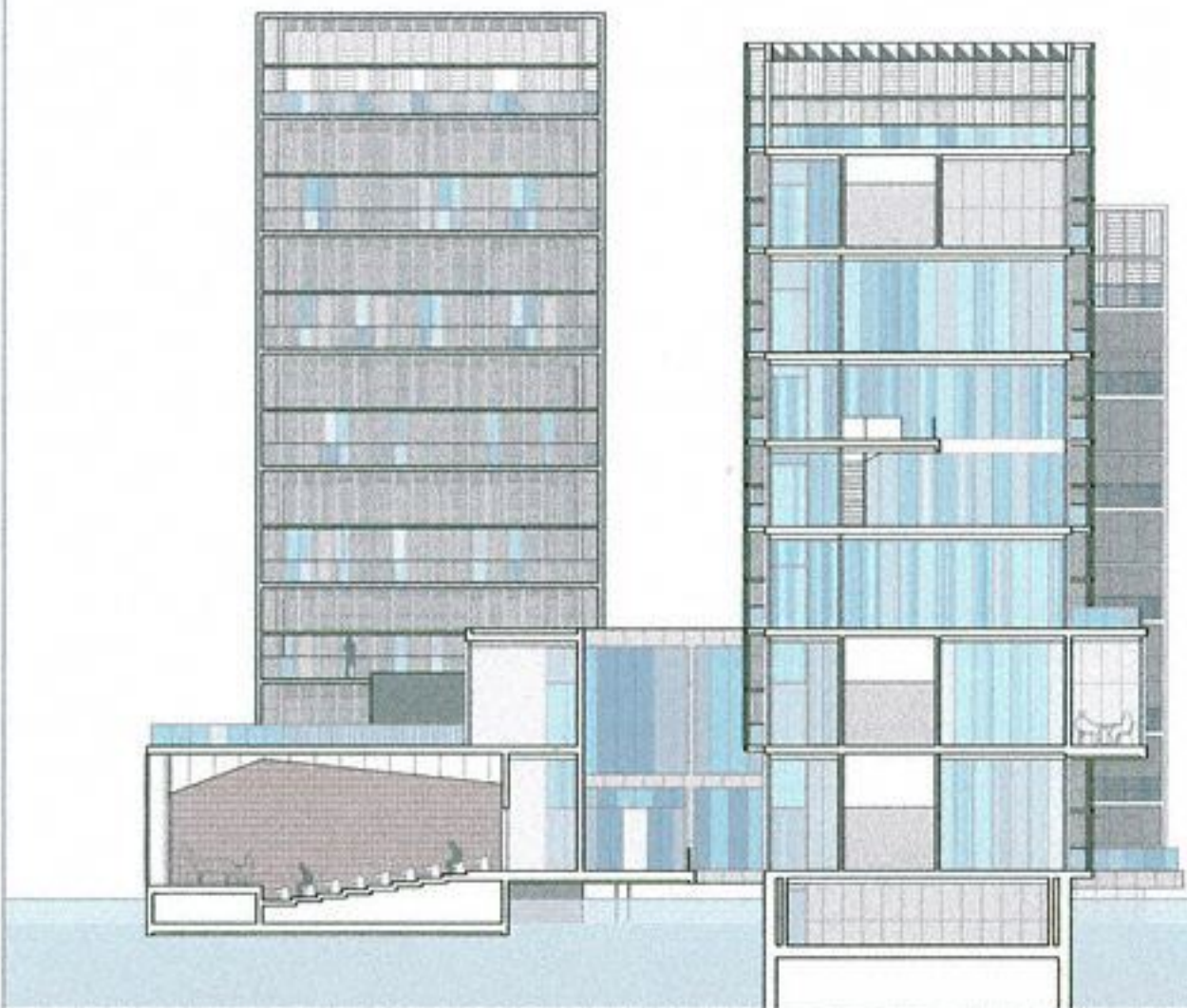
sección sala audición - torre de teatro e: 1/400
