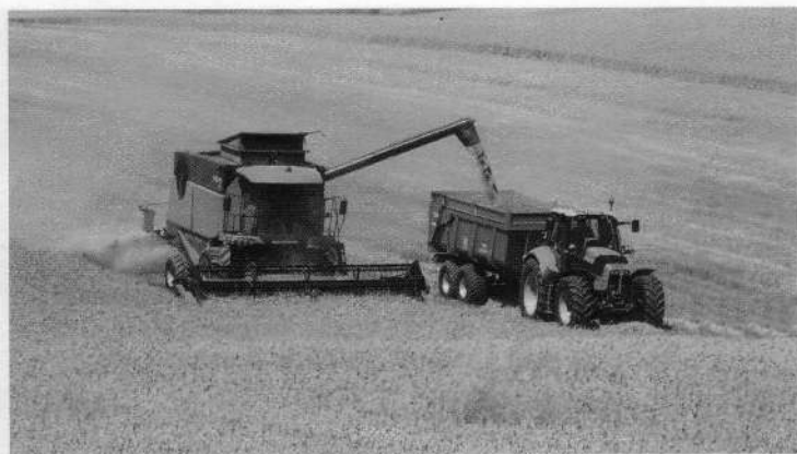
La mayoría de los fabricantes disponen de cosechadoras con sistema autonivelante del cabezal de recolección para evitar atascos de material.
