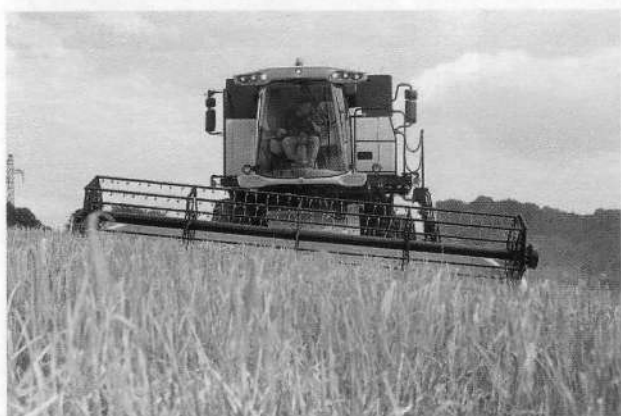
La mayoría de los fabricantes disponen de cosechadoras con sistema autonivelante del cabezal de recolección para evitar atascos de material.
