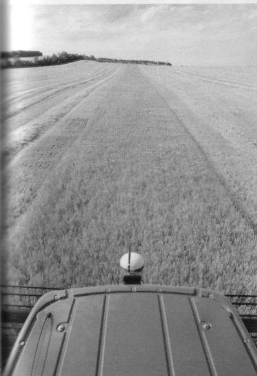
La antena GPS debe estar situada sobre la cabina, en posición centrada y más alta que la tolva.
