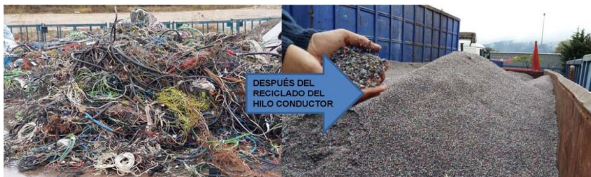
Fig. 1: Granza obtenida tras el reciclaje del hilo conductor de cables en desuso. Empresa Lyrsa Álava.
