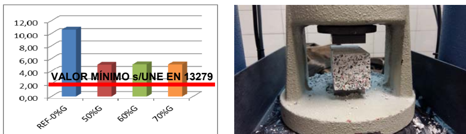
Fig. 6: Resistencia a compresión a los 7 días (N/mm 2 ).
