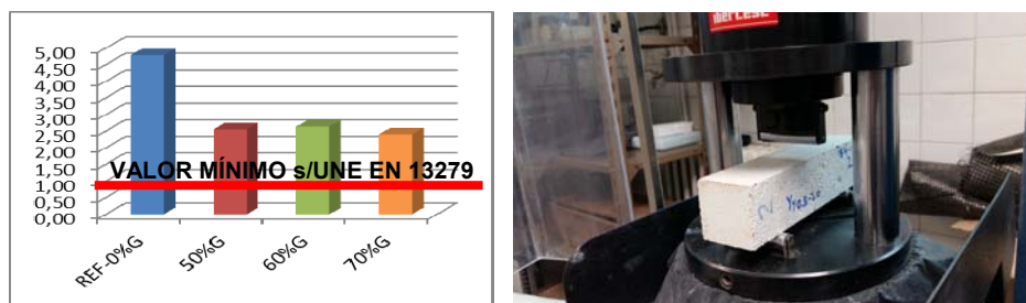
Fig. 5: Resistencia a flexión a los 7 días (N/mm 2 ).
