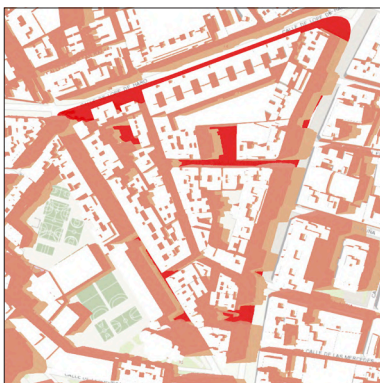
fig. 3.3.14. Incidencia de la radiación solar en la supermanzana para un mes de Julio. Arriba situación de mañana, a mitad mediodía y abajo tarde. Zonas más expuestas en color rojo Fuente: elaboración propia
