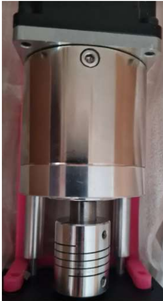
Figura 62.5: Soporte del Motor
