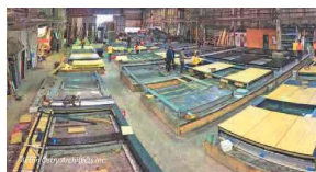
Fig 1.14. Prefabricación de los paneles de fachada
