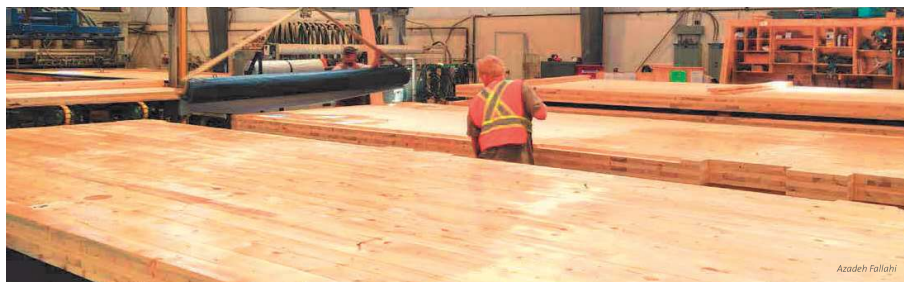
Fig. 1.11. Prefabricación, de los paneles de CLT
