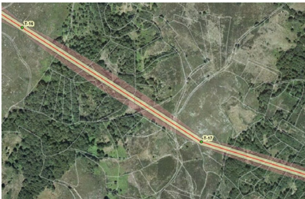
Figura 7. Ejemplo de cartografía catastral y afecciones de línea eléctrica sobre ortoimagen. Fuente: REE.
