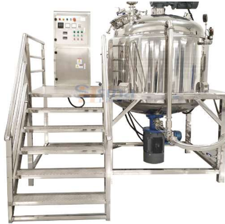
Figura 10. Tanque de mezcla
