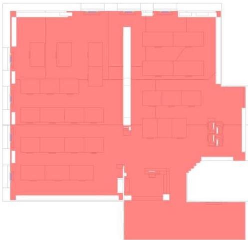
Figura 58. Confort CFD: PPD de la sala de lectura (mes de mayo)
