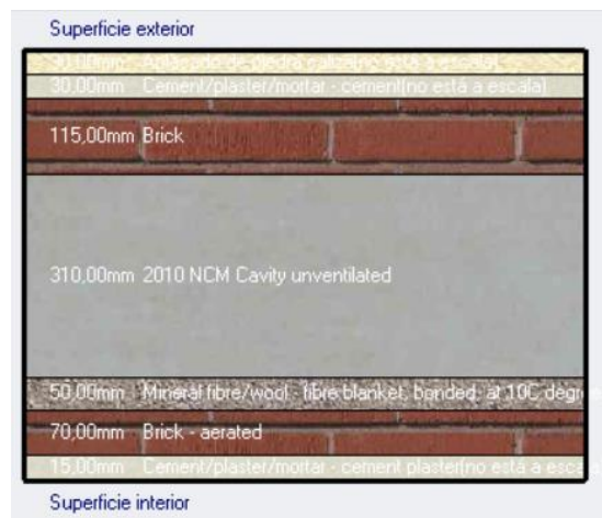
Figura 30. Composición de fachada
