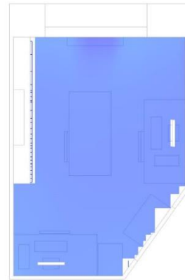
Figura 68. Edad del aire (s) del despacho 1 (mes de marzo)
