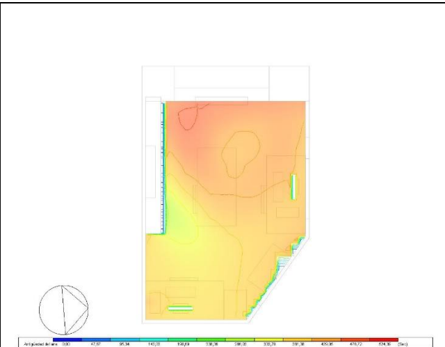
Figura 132. Edad del aire (s) del despacho 1
