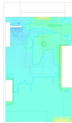
Figura 91. Confort CFD: PMV del despacho 2 (mes de diciembre)
