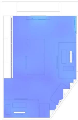
Figura 63. Velocidad del aire (m/s) del despacho 1 (mes de febrero)
