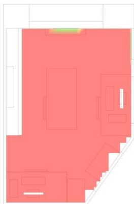
Figura 77. Confort CFD: PPD del despacho 1 (mes de mayo)
