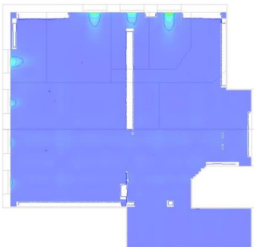
Figura 46. Velocidad del aire (m/s) de la sala de lectura (mes de mayo)
