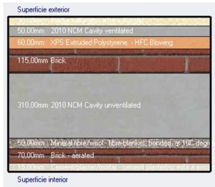
Figura 123. Composición de la fachada ventilada
