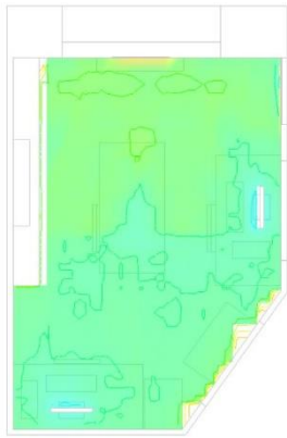
Figura 71. Confort CFD: PMV del despacho 1 (mes de febrero)
