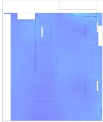
Figura 97. Velocidad del aire (m/s) del despacho 3 (mes de febrero)
