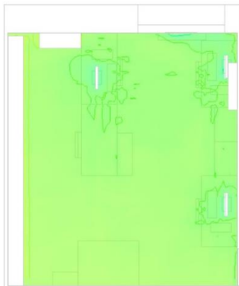
Figura 107. Confort CFD: PMV del despacho 3 (mes de mayo)
