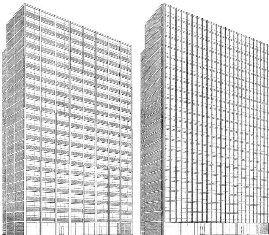
Fig. 5.3.3. Ludwig Mies van der Rohe, Promontory Apartments (Chicago, 1946-1949). Versión en hormigón armado (izquierda) y en hierro y vidrio (derecha). En la primera opción, nótese la reducción del espesor de los pilares a medida que el edificio crece en altura. Dibujos de Myron Goldsmith.
