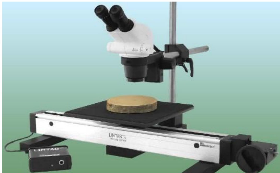
Figura 1.2. Plataforma LinTab (Rinntech, Heidelberg, Alemania) de medición lineal de anillos de árboles para discos de tronco y testigos de madera. Fuente: https://rinntech.info/products/lintab/ .
