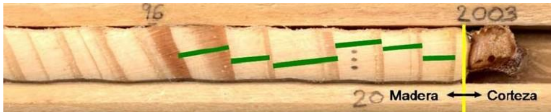
Figura 1.1. Testigo de madera pegado, pulido y datado sobre un soporte de madera. El último año de crecimiento todavía sin acabar es el 2003, justo debajo de la corteza. Fuente: Gutiérrez (2009).
