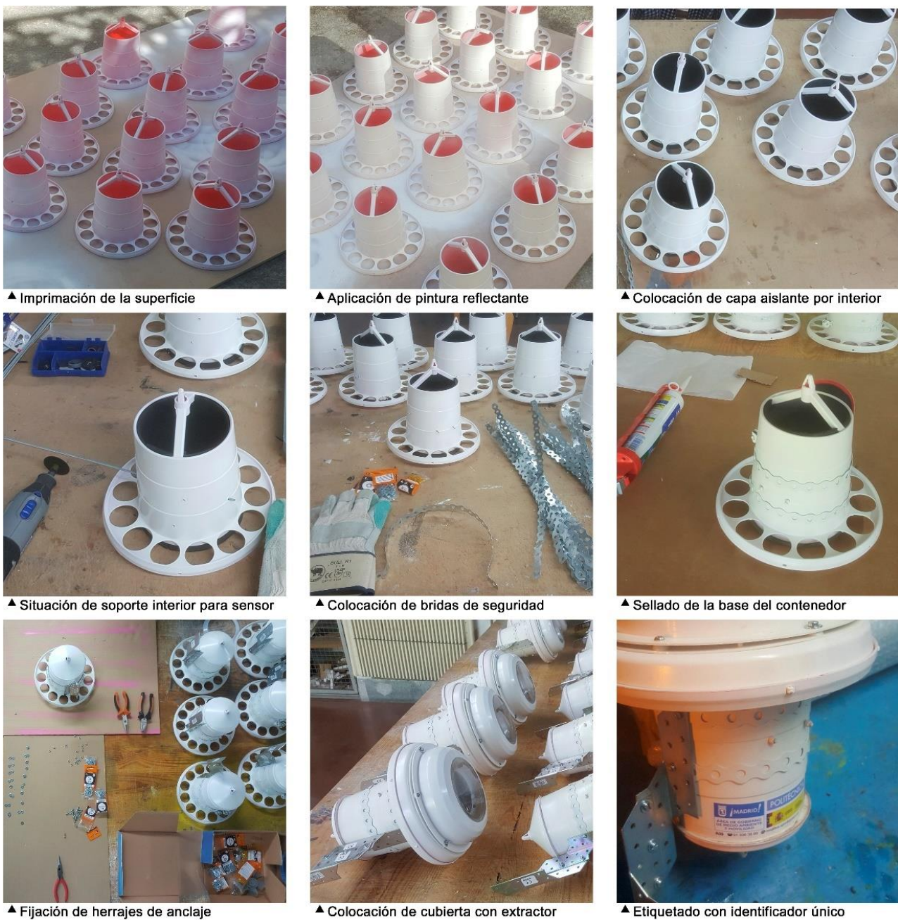
Figura 10.8 Imágenes del proceso de fabricación de la protección de los sensores.
