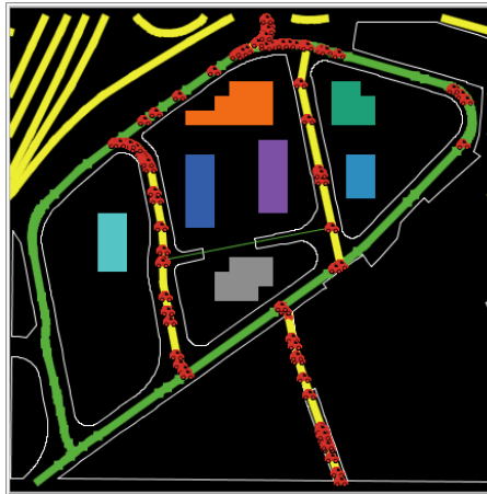
Fig. 24 Mapa con los accidentes resultantes de simular el escenario 2 donde se abren las calles cortadas del campus sur de la UPM
