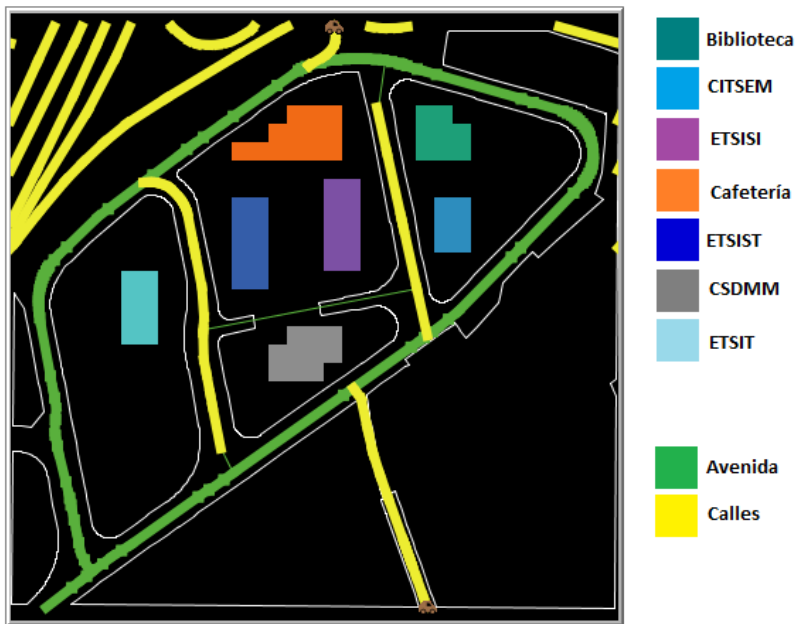
Fig. 4 Representación gráfica del entorno de simulación con la leyenda por colores de tipos de vías y destinos posibles para los agentes dinámicos
