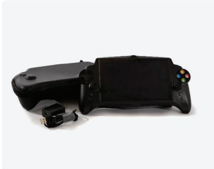
Figura 6. Controladora de serie para Spot. [8]
