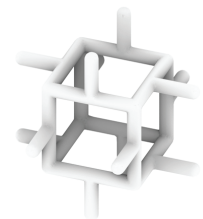
Estructura de Gibson y Ashby.
