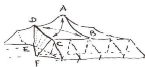
2.11 Envolvente de la jaima en forma trapezoidal para resistir los fuertes vientos.
