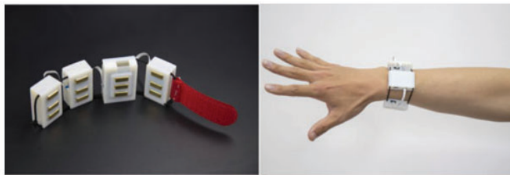
Figura 2.4: Prototipo de pulsera con el IMU y los sensores de EMG ([Jiang et. al (2017)]).
