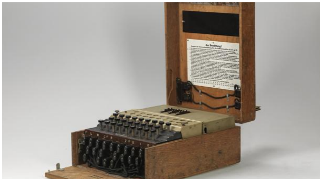
Figura 1.1: Máquina Enigma alemana. Máquina Enigma alemana usada para cifrar comunicaciones durante la Segunda Guerra Mundial.
