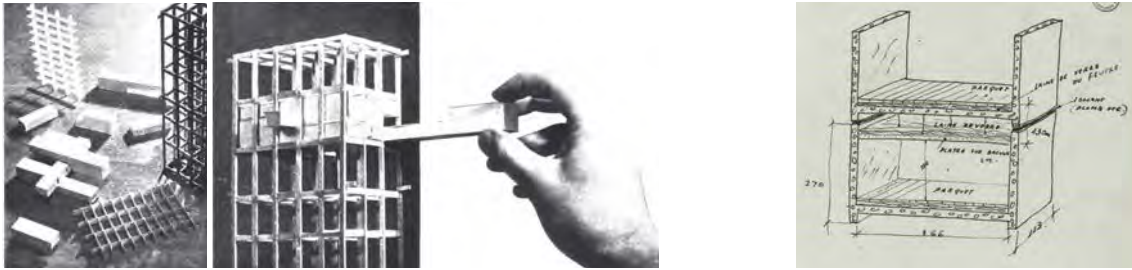
Distintas fotografías publicadas en las Œuvre complète de la maqueta conceptual (Izquierda); Diagrama sobre el sistema de insonorización "Insononsation II" (Derecha). Unité d'Habitation en Marsella. Le Corbusier.
