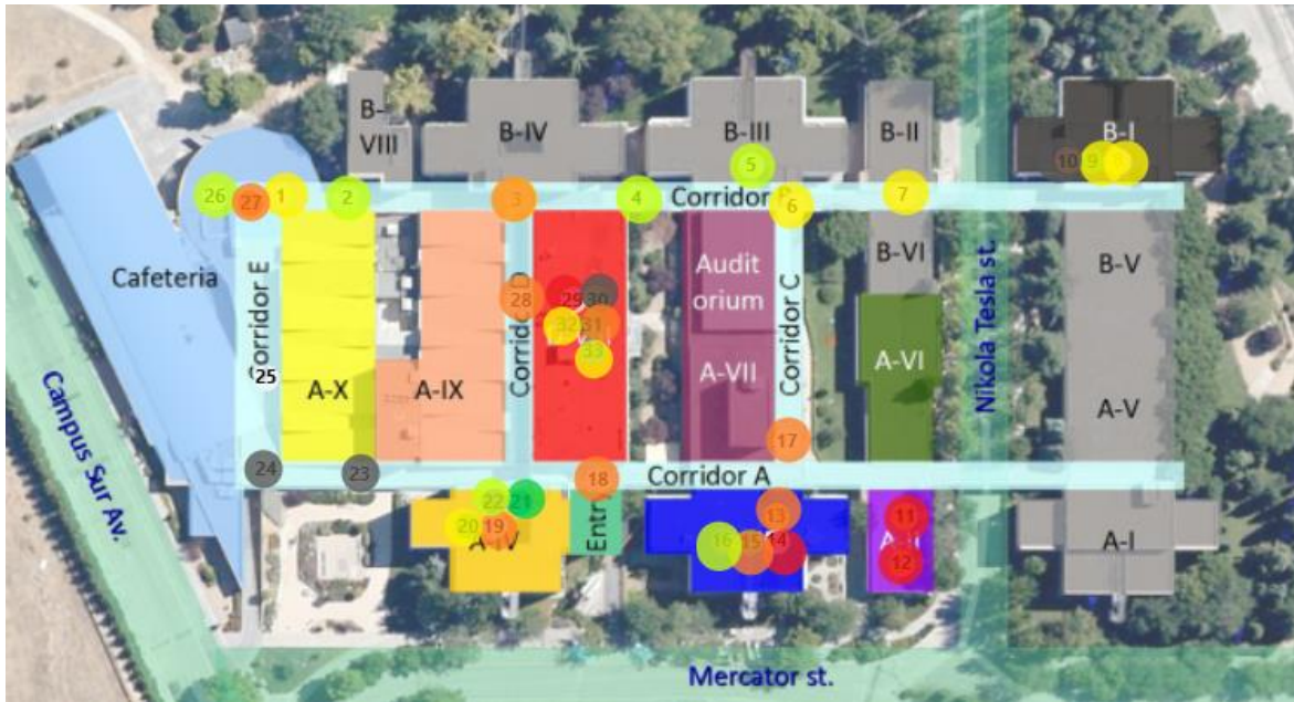
Figura 30.- Medidas nivel de señal rssi de NB-IoT de la mota SODAQ SARA en los edificios de la ETSIST
