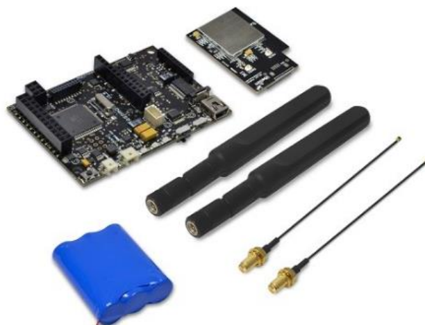
Figura 14.- Libelium WASPMOTE con módulo NB-IoT y 2 antenas.
