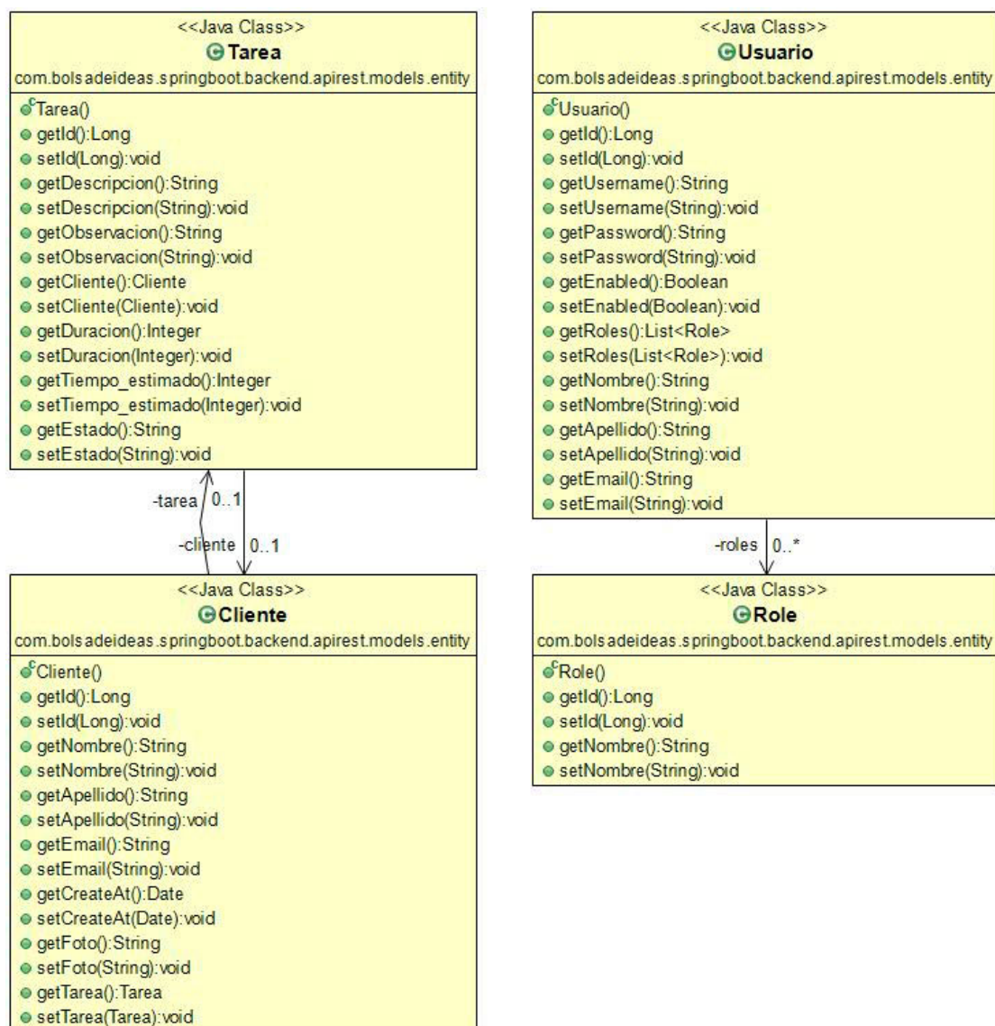
Ilustración 14 - Diagrama de clases paquete Entity
