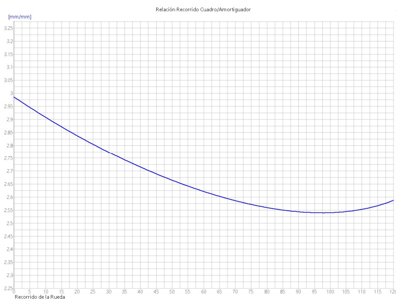
Figura 34. Leverage ratio de la bicicleta diseñada. Fuente: Propia.
