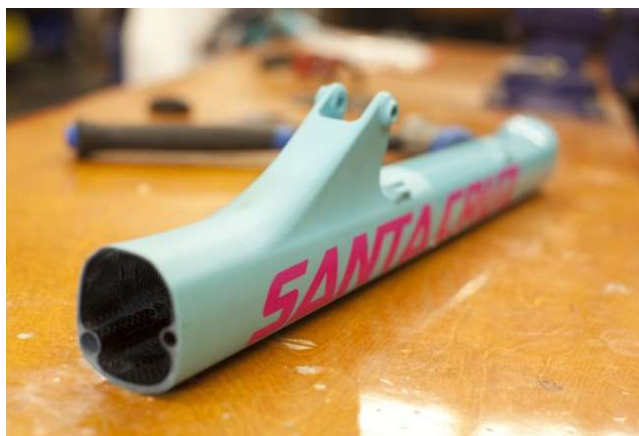
Figura 16. Guiado de cables interno. Fuente: Santa Cruz.
