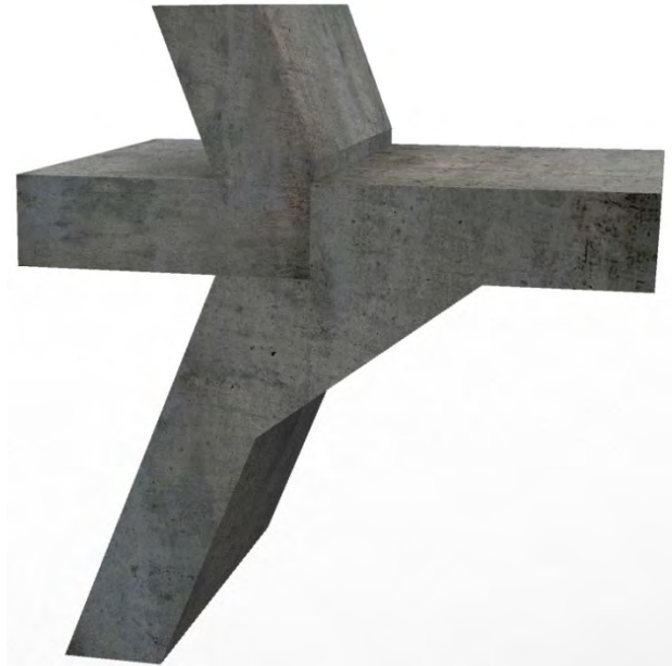
Imagen 9 Nudo de hormigón, unión de módulos (Elaboración del autor)
