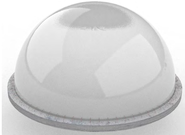
Imagen 43 Proceso constructivo de las Bubble house: colocación del globo y anillo de cimentación (Elaboración del autor)
