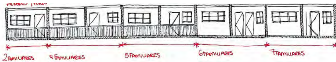
Imagen 67 Alzado norte "individual" de cada vivienda según el número de ocupantes (Elaboración del autor)
