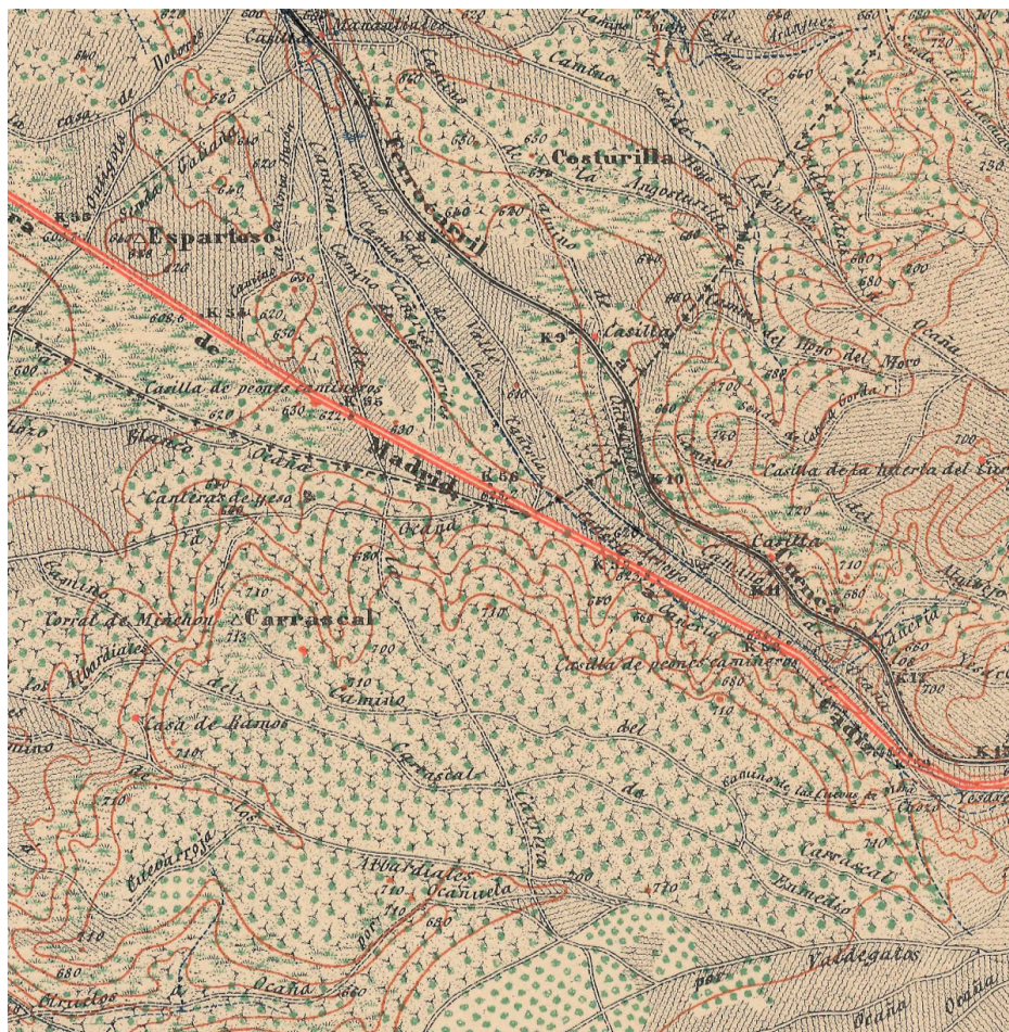
Fig. 1.1.17 INSTITUTO GEOGRÁFICO Y ESTADÍSTICO, 1880. Mapa topográfico nacional. Serie 1:50000; (MTN50). [Detalle de cartografía]. Puede verse representado en línea discontinua la conducción del viaje de agua bajo el rótulo de «cañería».
