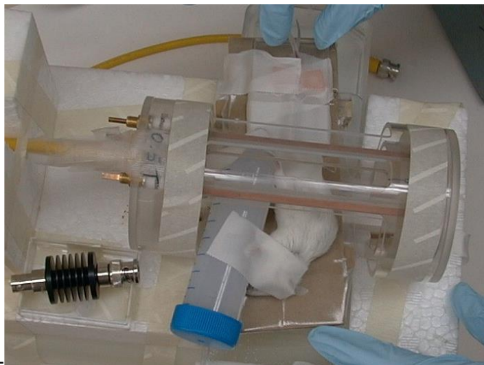
Figura 2-10. Fotografía de un saddle construido para un equipo clínico ubicado en el Advanced Technology Center and Radiology Institute del Sheba Medical Center de Tel Hashomer en Israel de 0.5 T.
