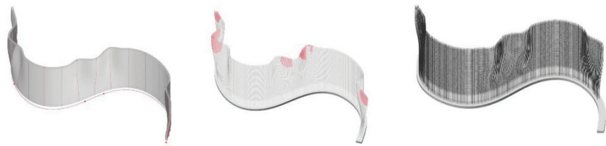
Figura 3.22. Diseño paramétrico del muro portante.
