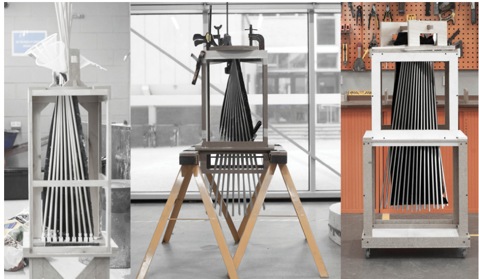
Figura 0.12. Colocación del molde en posición para realizar el vertido del hormigón.
