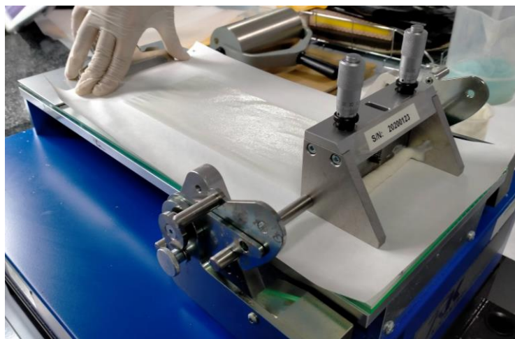
Figura 33. Papel siendo recubierto con mezcla de almidón-cera.
