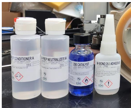
Figura 49: Productos necesarios para la correcta preparación superficial de la muestra a ensayar
