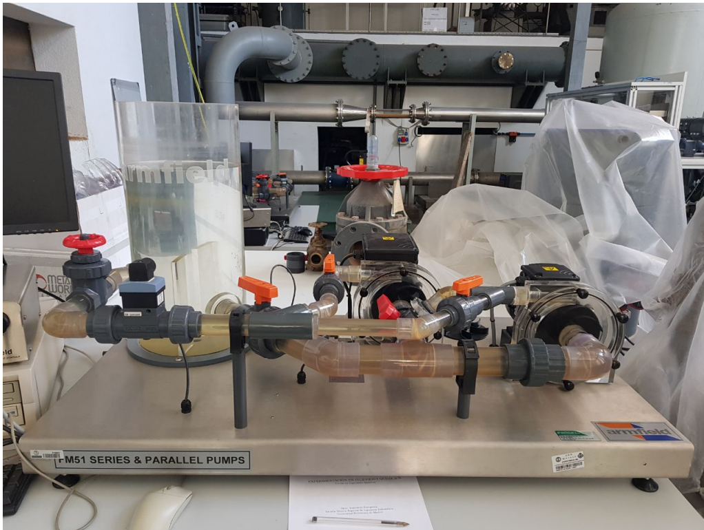
Figura 1.1: Banco de ensayo bombas serie/paralelo 1. Fuente: E.P.
