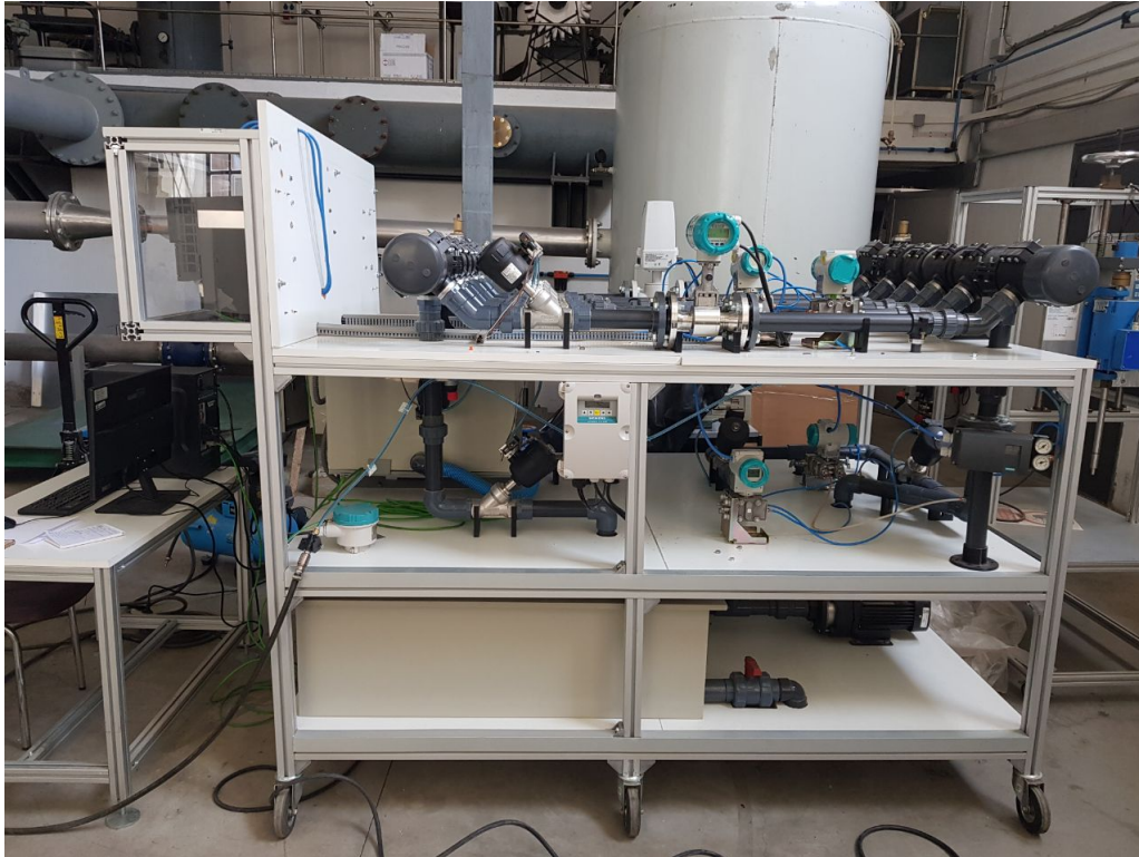
Figura 2.3: Módulo de estructura en el montaje final. Placas de contrachapado blanco que soportan el resto de elementos del banco. Fuente: E.P.
