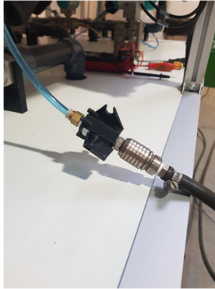
Figura 3.33: Detalle conexión del compresor con el banco. Fuente: E.P.
