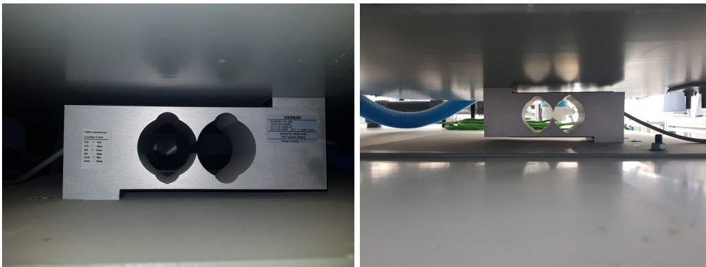
Figura 3.8: Célula de carga y detalle de sus características. Fuente: E.P.
