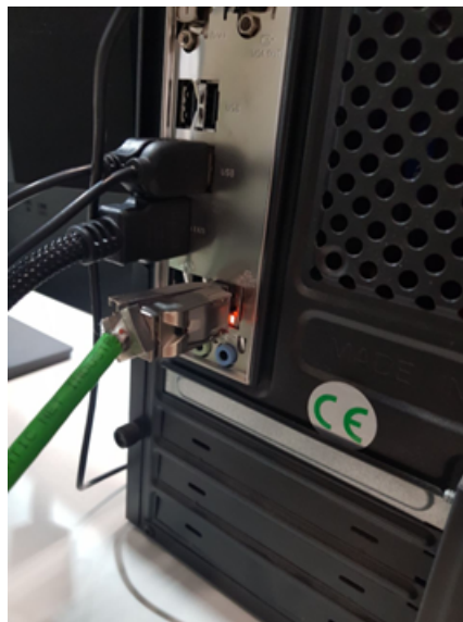
Figura 3.40: Conexión cable ethernet. Fuente: E.P.
