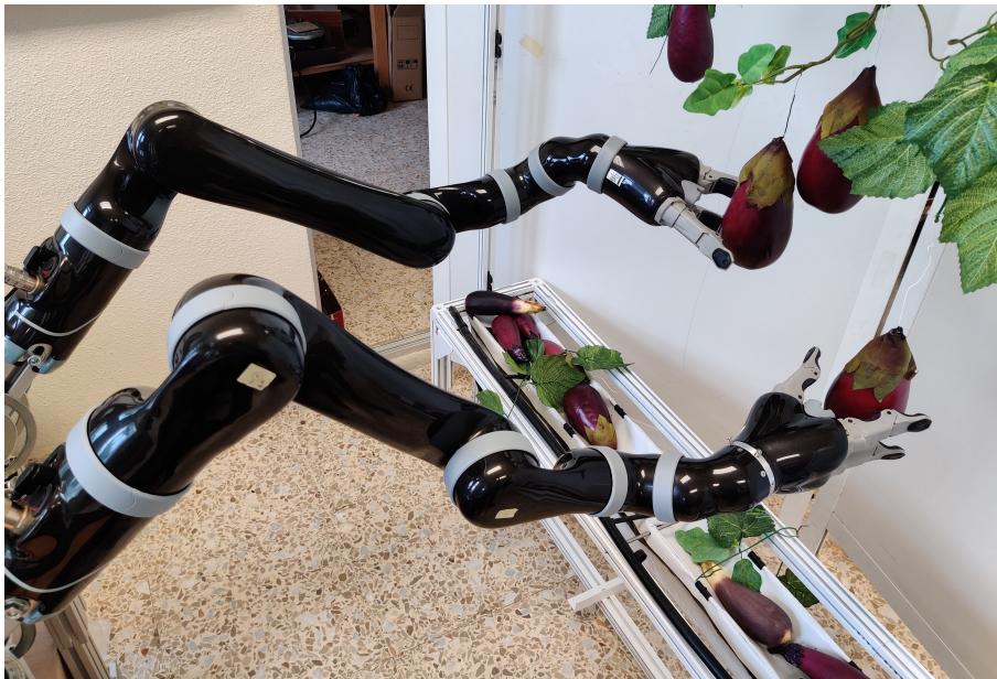
Figura 2.4: Brazos robóticos MICO2 TM recolectando berenjenas.
