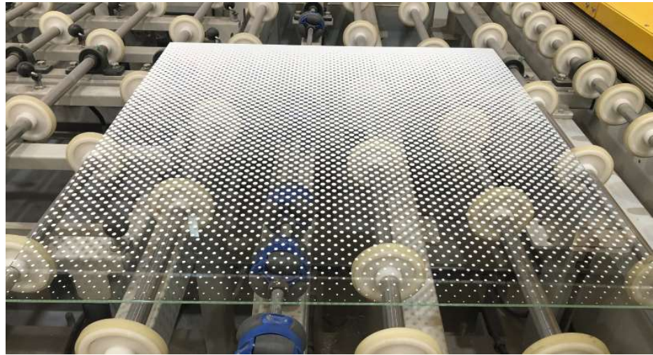
Figura 4.37. (encima) Serigrafía con degradado de tinta blanca (Ramos).
