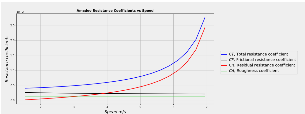
Figura D.4: Coeficientes resistivos del método de Amadeo obtenidos de FreeCAD Ship para el buque 1.
