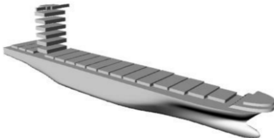
Figura 8.12: Formas de un buque portacontenedores de 4600 TEUS obtenida a través de [4]
