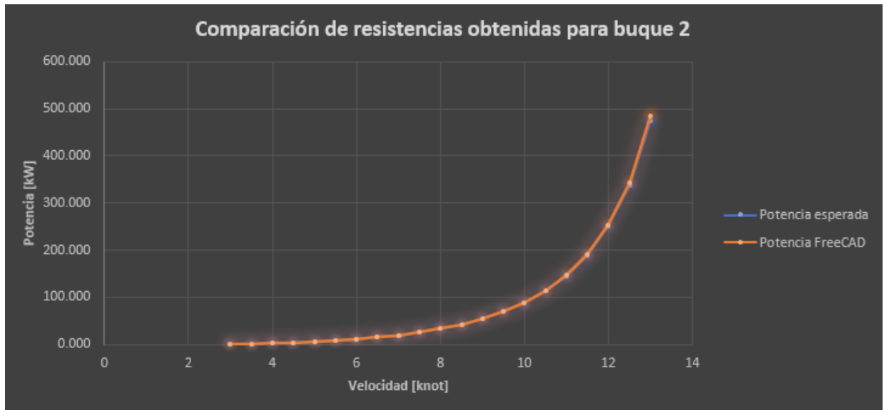
Figura D.7: Gráfica comparativa de las potencias efectivas obtenidas para el buque 2 en el método de Amadeo.
