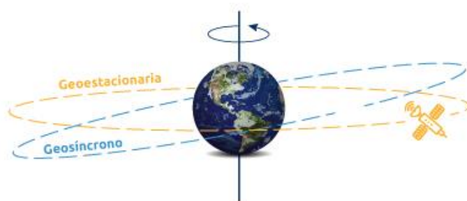
Ilustración 8: Órbitas satélites Geosíncronos y Geoestacionarios [https://axessnet.com/que-son-y-para-que-sirven-los-satelites-geoestacionarios/]
