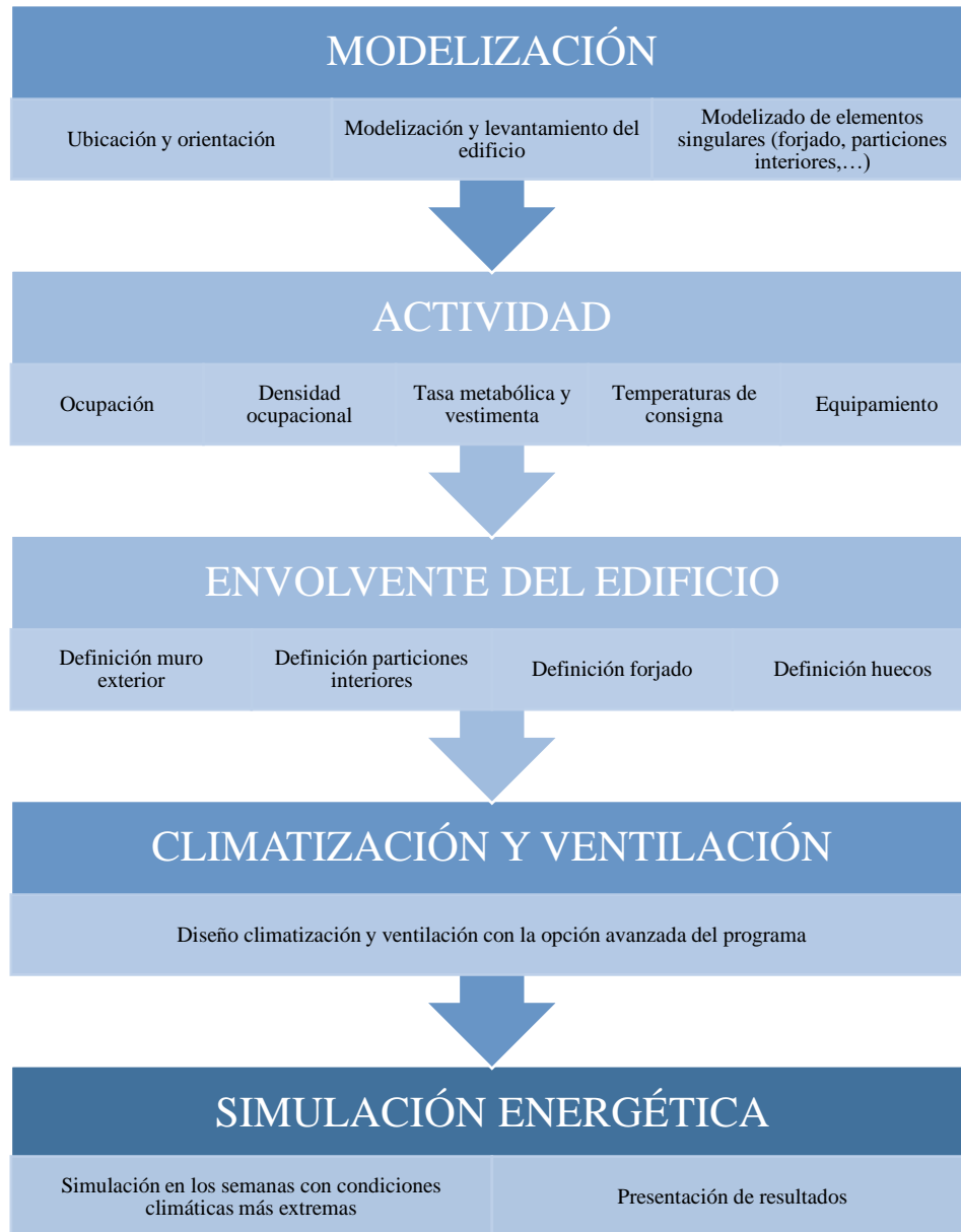
Figura 35: Metodología para realizar la simulación en el software DesignBuilder
