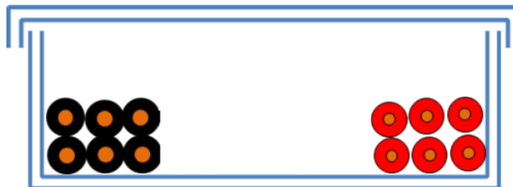
Figura 7.24. Disposición de los cables. Modificado de [29]
