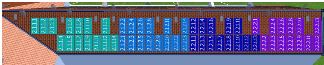
Figura 7.13. Distribución de los paneles según el inversor [Elaboración propia]
