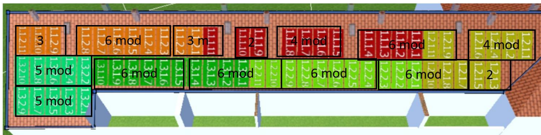
Figura 7.46. Distribución de los módulos Este 1 según estructuras
