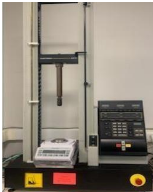
Figura 2.2: Máquina Universal de ensayos Instron 4411. Compuesto por un bastidor, cabeza de carga, actuador, celda de carga, Software de control y dispositivo de sujeción.
