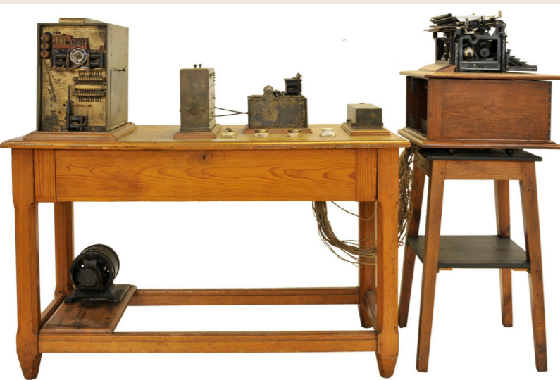
IZQUIERDA: VISTA EN ALZADO DEL ARITMÓMETRO ELECTROMECAÁNICO, CREADO EN 1920, CON LOS ELEMENTOS PROPIOS DE UN COMPUTADOR COMO SON LA UNIDAD ARITMÉTICA, LA UNIDAD DE CONTROL, UNA PEQUEÑA MEMORIA Y UN DISPOSITIVO DE ENTRADA Y SALIDA QUE EN ESTE CASO SE CONFIGURABA CON UNA MÁQUINA DE ESCRIBIR UNDERWOOD. LEONARDO TORRES QUEVEDO. FUENTE: CORTESÍA DEL MUSEO TORRES QUEVEDO, ESCUELA TÉCNICA SUPERIOR DE INGENIEROS DE CAMINOS, CANALES Y PUERTOS, UNIVERSIDAD POLITÉCNICA DE MADRID, MADRID. DERECHA: DIAGRAMA EN PLANTA DEL PRIMER Y SEGUNDO AJEDRECISTA. LABORATORIO DE AUTOMÁTICA. 1912 (PRIMER AJEDRECISTA, LEONARDO TORRES QUEVEDO). 1920 (SEGUNDO AJEDRECISTA, GONZALO TORRES QUEVEDO). FUENTE: CORTESÍA DEL MUSEO TORRES QUEVEDO, ESCUELA TÉCNICA SUPERIOR DE INGENIEROS DE CAMINOS, CANALES Y PUERTOS, UNIVERSIDAD POLITÉCNICA DE MADRID, MADRID. EXPOSICIÓN MÁS ALLÁ DE 2001. ODISEAS DE LA INTELIGENCIA. ESPACIO FUNDACIÓN TELEFÓNICA MADRID, MADRID (31 OCTUBRE 2018 - 17 FEBRERO 2019)
