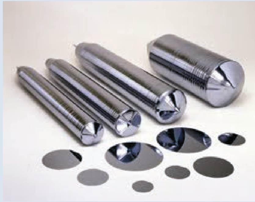
IMAGEN DE LAS BARRAS DE SILICIO PURO Y LAS OBLEAS QUE SE OBTIENEN DE ELLAS, LISTAS PARA IMPRIMIR LOS CIRCUITOS DE LOS COMPONENTES PASIVOS Y ACTIVOS DEL HARDWARE DE UN COMPUTADOR. FUENTE: OBLEA DE SILICIO (2010), ACCESO EL 9 DE JUNIO DE 2021 DESDE: HTTP://ALMADEHERRERO.BLOGSPOT.COM/2010/10/OBLEAS-DE-SILICIO.HTML
