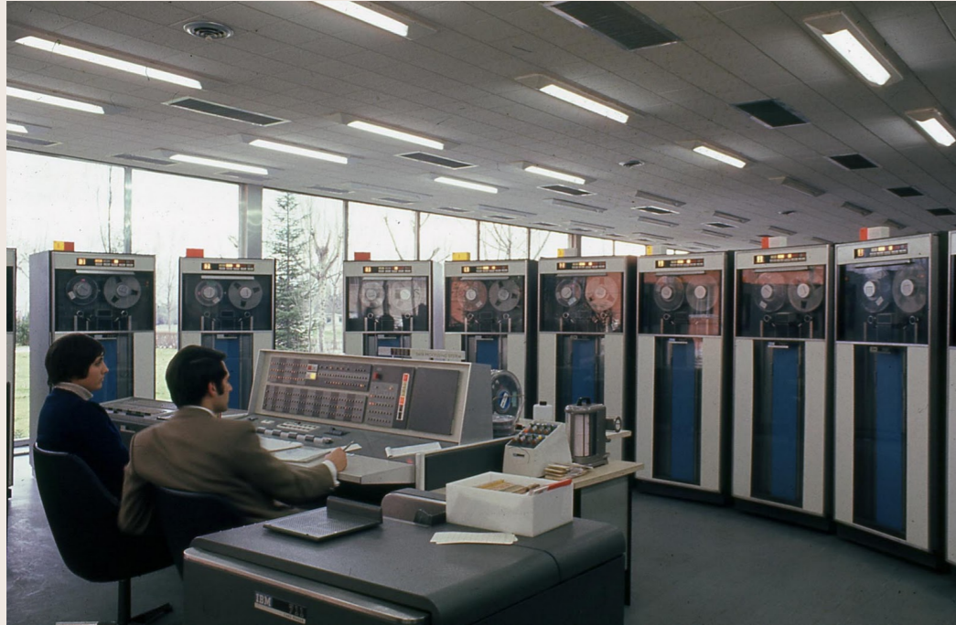
IMAGEN DEL INTERIOR DE LA SALA DE CONTROL O DE MÁQUINAS DEL CCUM CON LA CONSOLA PRINCIPAL Y LAS UNIDADES DE CINTAS Y SUS INDICADORES LUMINOSOS, JUNTO CON LAS PANTALLAS FLUORESCENTES BLANCANIEVES DISEÑADAS POR MIGUEL FISAC. CCUM. MADRID. MIGUEL FISAC. FUENTE: BRIONES MARTÍNEZ, F. (2012). CREACIÓN DEL CENTRO DE CÁLCULO DE LA UNIVERSIDAD DE MADRID. ACCESO EL 7 DE MARZO DE 2022 DESDE: HTTP://COSASQUEQUIEROCONTAR-FBM.BLOGSPOT.COM/2012/03/CREACION-DEL-CENTRO-DE-CALCULO-DE-LA.HTML
