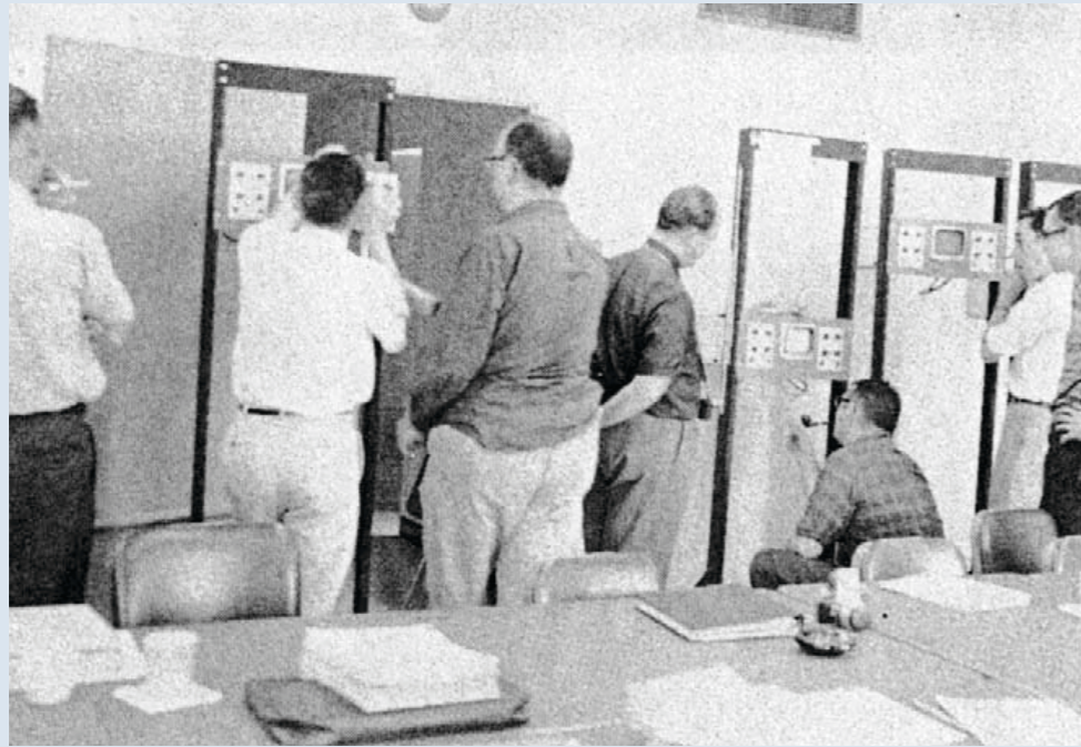
IMAGEN DEL TALLER DE VERANO LINC EVALUATION PROGRAM DE 1963. EN ELLA, SE VE A VARIOS/AS BIÓLOGOS/AS MONTANDO ELLOS/AS MISMOS EL DISPOSITIVO LINC. 1963. CERCA DE BOSTON. FUENTE: NOVEMBER, J. (2004). LINC: BIOLOGY'S REVOLUTIONARY LITTLE COMPUTER. ENDEAVOUR , 28(3), P. 130.
