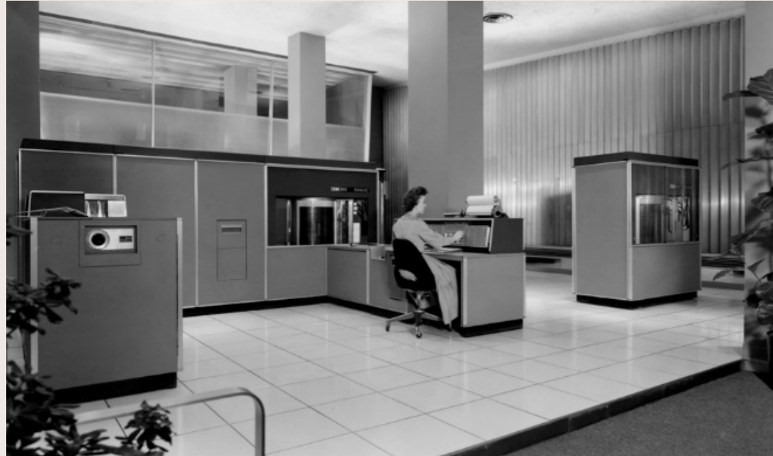
IMAGEN DEL ENORME COMPUTADOR IBM 305 RAMAC (RANDOM ACCESS METHOD OF ACCOUNTING AND CONTROL), SIMILAR AL QUE CONTENÍA LA CÚPULA GEODÉSICA QUE CONSTRUYÓ RICHARD BUCKMINSTER FULLER PARA EL PABELLÓN DE ESTADOS UNIDOS EN LA AMERICAN NATIONAL EXHIBITION DE MOSCÚ, EN 1959. EL 305 RAMAC SE UTILIZABA PARA ALMACENAR REGISTROS Y DATOS DE EMPRESAS Y NEGOCIOS. FUE EL PRIMER COMPUTADOR EQUIPADO CON DISCO DURO. CA. 1956. FUENTE: CORTESÍA DE LOS ARCHIVOS DEL COMPUTER HISTORY MUSEUM (ID: 102651965). ACCESO EL 23 DE MAYO DE 2020 DESDE: HTTPS://WWW.COMPUTERHISTORY.ORG/REVOLUTION/EARLY-COMPUTER-COMPANIES/5/111/471 .
