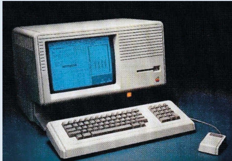
IMAGEN DEL COMPUTADOR PERSONAL APPLE LOCAL INTEGRATED SOFTWARE ARCHITECTURE O APPLE LISA (ANUNCIADO PARA LA PRIMAVERA DE 1983), FUE EL PRIMER COMPUTADOR PERSONAL QUE COMERCIALIZÓ APPLE CON UNA INTERFAZ GRÁFICA DE USUARIO/A (GIU) Y UN INTERFAZ PERIFÉRICO RATÓN. APPLE. 1983. FUENTE: WURSTER, C. (2002). COMPUTERS: AN ILLUSTRATED HISTORY . KÖLN: TASCHEN, P. 230.
