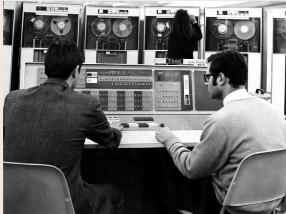
IMAGEN DE LA CONSOLA PRINCIPAL DEL IBM7090 EN LA SALA DE CONTROL DEL CCUM, CON LAS UNIDADES DE CINTAS AL FONDO. POSIBLEMENTE LA PERSONA DE LA IZQUIERDA FUERA ISIDRO RAMOS SALAVERT, ANALISTA, JUNTO CON EMILIO FLORES, JEFE DE OPERADORES. CA. 1969. CCUM. MADRID. MIGUEL FISAC. FUENTE: LÓPEZ, J. A. [2012]. DEL CÁLCULO NUMÉRICO A LA CREATIVIDAD ABIERTA: EL CENTRO DE CÁLCULO DE LA UNIVERSIDAD DE MADRID, 1965-1982 . MADRID: UNIVERSIDAD COMPLUTENSE DE MADRID, P. 14.
