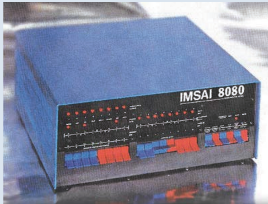
IMAGEN DEL COMPUTADOR PERSONAL IMSAI 8080, UNA COPIA DEL ALTAIR 8800. SU PRECIO ERA MÁS ELEVADO PORQUE OFRECÍA UNA OPCIÓN EN LA QUE EL COMPUTADOR YA SE PODÍA ADQUIRIR MONTADO Y NO EN FORMA DE KIT. 1977. FUENTE: WURSTER, C. (2002). COMPUTERS: AN ILLUSTRATED HISTORY . KÖLN: TASCHEN, P. 150.
