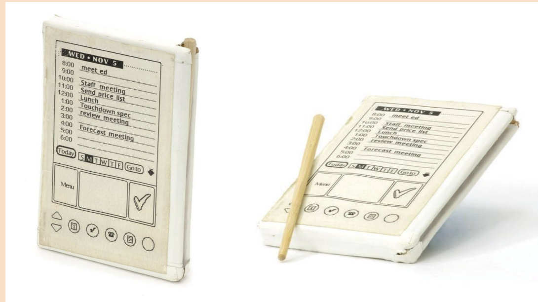
IMÁGENES DEL PROTOTIPO DEL COMPUTADOR DE MANO (HANDHELD (H)) PALMPILOT QUE SE TOCABA Y ACARICIABA MEDIANTE UN LÁPIZ ÓPTICO. CA. 1995. 1,6 CM ESPESOR, 12,4 CM DE ALTO Y 8,6 CM. OCUPABA UNA SUPERFICIE DE 0,010 M2. FUENTE: CORTESÍA DEL COMPUTER HISTORY MUSEUM (ID: 102716262).
