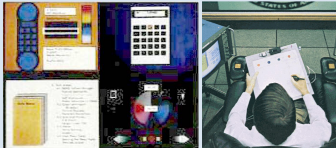
IZQUIERDA; LA PANTALLA SDMS , FRENTE A LA BUTACA DE LOS EAMES, MOSTRABA UNA CALCULADORA, UN CALENDARIO Y UN TELÉFONO EN FUNCIONAMIENTO. EN ESE MOMENTO FUERON RIDICULIZADOS, PERO TALES UTILIDADES DE ESCRITORIO AHORA SON COMUNES EN LAS COMPUTADORAS PERSONALES: TELÉFONOS INTELIGENTES, TABLETAS Y TODO TIPO DE DISPOSITIVOS TECNOLÓGICOS. MEDIA ROOM / SPATIAL DATA-MANAGEMENT SYSTEM / DATALAND, 1976. MIT ARCHITECTURE MACHINE GROUP. RICHARD A. BOLT. FUENTE: BRAND, S. (1987). THE MEDIA LAB: INVENTING THE FUTURE AT MIT . NEW YORK: VIKING PENGUIN, P. 151. DERECHA: UNO DE LOS INTERFACES CON LOS QUE CONTABA MEDIA ROOM. LA AUSENCIA DELIBERADA DE TECLADO ALFANUMÉRICO ABRIÓ LA PUERTA A UNA MULTIPLICIDAD DE SUPERFICIES SENSIBLES Y TÁCTILES QUE INUNDABAN LOS ESPACIOS, PRECURSORAS DE LAS ACTUALES TABLETAS O EL IPAD. MEDIA ROOM / SPATIAL DATA-MANAGEMENT SYSTEM / DATALAND, 1976. MIT ARCHITECTURE MACHINE GROUP. RICHARD A. BOLT. FUENTE: HOUSTON, T. (2012). DATALAND: THE MIT'S '70S MEDIA ROOM CONCEPT THAT INFLUENCED THE MAC. ACCESO EL 24 DE ENERO DE 2022 DE: HTTPS://WWW.THEVERGE.COM/2012/5/24/3040959/DATALAND-MITS-70S-MEDIA-ROOM-CONCEPT-THAT-INFLUENCED-THE-MAC
