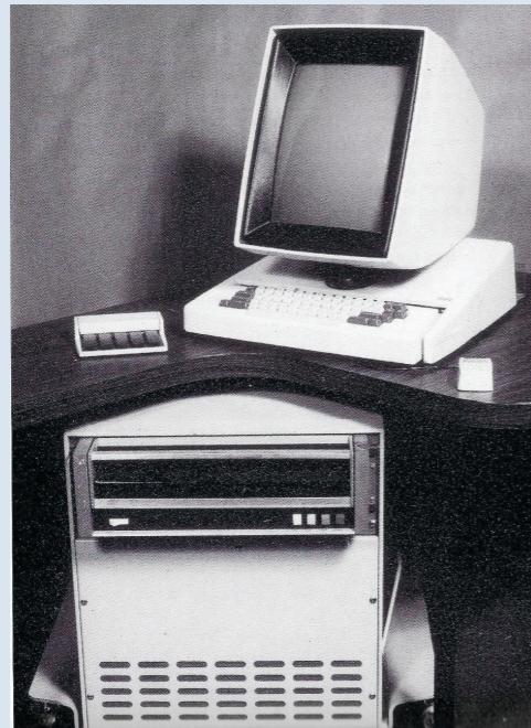
IMAGEN DEL THE ALTO, EL DC TIPO ESTACIÓN DE TRABAJO, DESARROLLADO POR EL PALO ALTO RESEARCH CENTER O PARC DE XEROX. 1974. FUE EL PRIMER COMPUTADOR EQUIPADO CON UNA INTERFAZ GRÁFICA DE USUARIO/A (GUI) ANTES QUE EL MACINTOSH. FUE DESARROLLADO SOBRE TODO POR ALAN C. KAY, COMO UNA INNOVACIÓN DECISIVA EN COMPUTACIÓN DEL LADO DEL SOFTWARE. FUENTE: WURSTER, C. (2002). COMPUTERS: AN ILLUSTRATED HISTORY . KÖLN: TASCHEN, P. 228.
