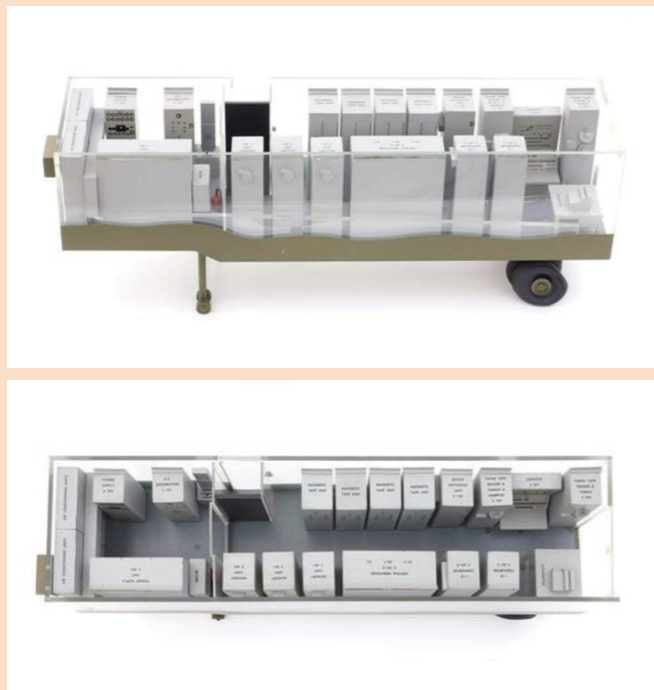
IMÁGENES DE LA MAQUETA DEL COMPUTADOR TIPO MAINFRAME PORTÁTIL MOBIDIC O MOBILE DIGITAL COMPUTER. EJÉRCITO DE LA ARMADA ESTADOUNIDENSE. SYLVANIA ELECTRIC PRODUCTS. 1958. FUENTE: CORTESÍA DEL COMPUTER HISTORY MUSEUM (ID: X205.83).
