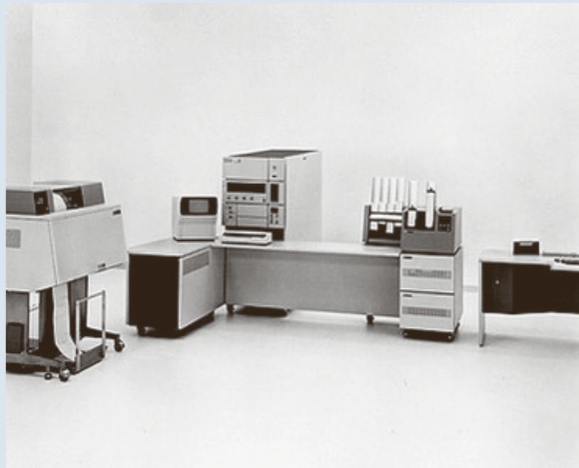
IBM SYSTEM/3. 1969. EL 30 DE JUNIO DE 1969 IBM PRESENTÓ SU MINICOMPUTADOR SYSTEM/3 (IBM 5410) QUE FUE EL PRIMERO EN SEPARAR Y VENDER POR SEPARADO EL HARDWARE Y EL SOFTWARE. FUENTE: IBM ARCHIVES. ACCESO EL 07 DE FEBRERO DE 2022 DESDE: HTTPS://WWW.IBM.COM/IBM/HISTORY/EXHIBITS/ROCHESTER/ROCHESTER_4008.HTML
