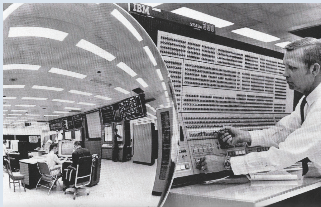
IMAGEN DEL IBM SYSTEM/360 MODELO 75, EN LAS INSTALACIONES DE LA ESTACIÓN TERRESTRE APOLLO, EN GREENBELT, MARYLAND, QUE SE ENCARGÓ DE CONTROLAR EL CURSO Y LA ÓRBITA LUNAR DE LA NAVE ESPACIAL APOLLO 12. ESTE DC ESTABA CONSTANTEMENTE CONECTADO CON OTROS CINCO COMPUTADORES UBICADOS EN EL CENTRO ESPACIAL JOHNSON, EN HOUSTON, TEJAS Y FUE UTILIZADO PARA CALCULAR LOS EFECTOS DE LOS POSIBLES CAMBIOS DE RUMBO DE LA NAVE EN SU MISIÓN. 1969. FUENTE: CORTESÍA DE IBM, WURSTER, C. (2002). COMPUTERS: AN ILLUSTRATED HISTORY . KÖLN: TASCHEN, P. 62.
