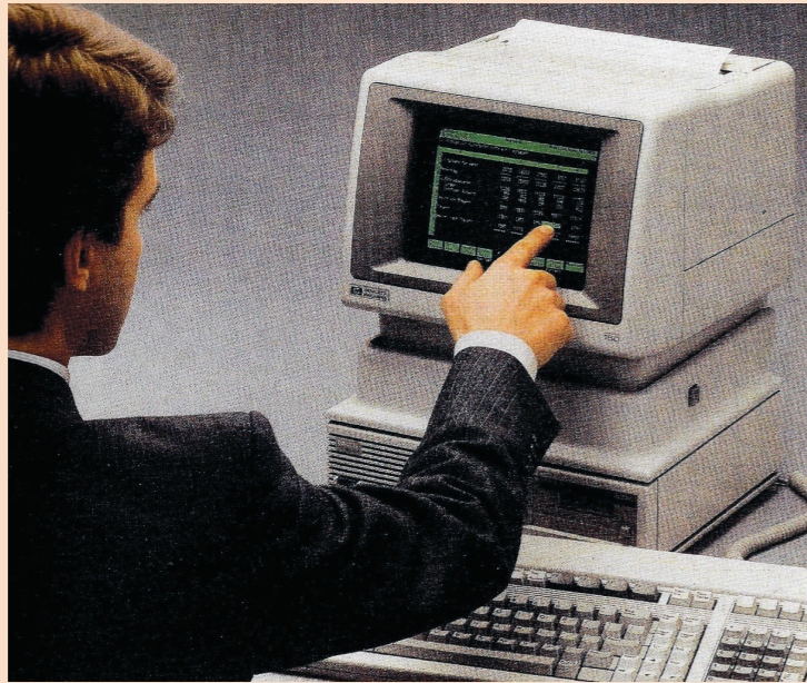
IMAGEN DEL PRIMER DISPOSITIVO COMPUTADOR TÁCTIL DEL MERCADO. PODÍA SER MANIPULADO TOCANDO LOS DISTINTOS OBJETOS CON LOS DEDOS EN SU PANTALLA. HP 150. HEWLETT-PACKARD. ESTADOS UNIDOS. 1983. FUENTE: WURSTER, C. (2002). COMPUTERS: AN ILLUSTRATED HISTORY . KÖLN: TASCHEN, P. 211.
