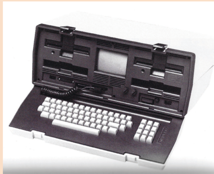
IMAGEN DEL MICROCOMPUTADOR PORTÁTIL OSBORNE 1. DISEÑADA POR ADAM OSBORNE. OSBORNE COMPUTER CORPORATION. PESABA 11 KILOS. FUENTE: WURSTER, C. (2002). COMPUTERS: AN ILLUSTRATED HISTORY . KÖLN: TASCHEN, P. 202.
