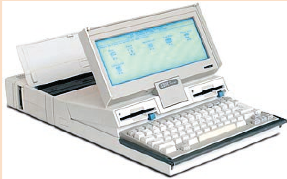
IMAGEN DEL MICROCOMPUTADOR PORTÁTIL IBM CONVERTIBLE PC (5140 CONVERTIBLE) ABIERTO, COPIANDO LA ESTRATEGIA DE DISEÑO DEL GRID. IBM. 1986-1987. FUENTE: ACCESO EL 11 DE MAYO DE 2021 DESDE: HTTPS://OLDCOMPUTERS.NET/IBM5140.HTML
