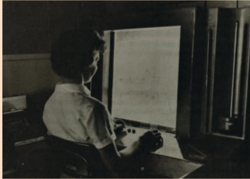
IMAGEN DE UNA MUJER OPERARIA TRANSCRIBIENDO SÍMBOLOS ORTOGRÁFICOS EN TARJETAS PERFORADAS PARA REALIZAR GRÁFICOS Y DIBUJOS POSTERIORMENTE EN EL DISPOSITIVO COMPUTADOR BENSON-LEHNER «OSCAR». DIVISIÓN AEROSPACIAL DE THE BOEING COMPANY. 1964. FUENTE: FETTER, W. A. (1964). COMPUTER GRAPHICS IN COMMUNICATION (1ª ED.). NUEVA YORK: MCGRAW HILL, P. 18.
