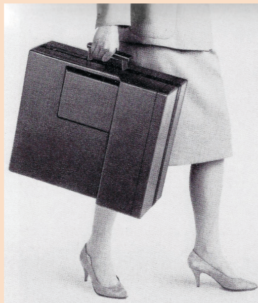
IMAGEN DEL COMPUTADOR PERSONAL PORTÁTIL OLIVETTI M21 (XP850) PLEGADO Y TRANSPORTADO POR SU ASA POR UNA PERSONA. FUE LA RESPUESTA EUROPEA A LOS PRIMEROS LAPTOPS. OLIVETTI S.P.A. ITALIA. 1984. FUENTE: WURSTER, C. (2002). COMPUTERS: AN ILLUSTRATED HISTORY . KÖLN: TASCHEN, P. 217.
