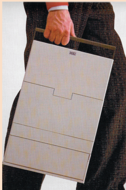
IMAGEN DEL MICROCOMPUTADOR PORTÁTIL IBM CONVERTIBLE PC (5140 CONVERTIBLE) PLEGADO, SIENDO TRANSPORTADO POR SU ASA POR UNA PERSONA. FUENTE: WURSTER, C. (2002). COMPUTERS: AN ILLUSTRATED HISTORY . KÖLN: TASCHEN, P. 217.
